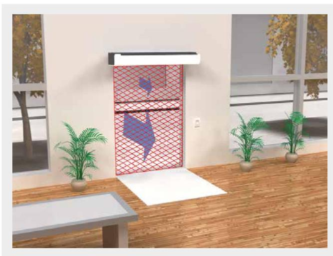
Ajustando los requisitos para la velocidad del aire y la uniformidad del flujo de aire al nivel del suelo, obtendrá una cortina de aire que cubra todo el hueco de la puerta.
