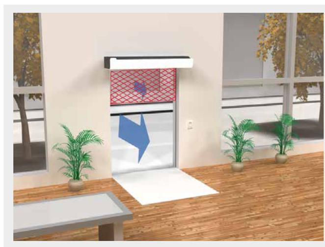
Si elige una cortina de aire en función únicamente del volumen de aire, tendrá una cortina de aire que solo le ofrecerá una buena protección cerca de la salida, donde el impacto en el hueco de la puerta es menor.
