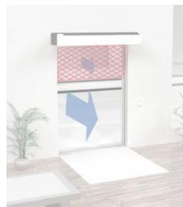
Si elige una cortina de aire en función únicamente del volumen de aire, tendrá una cortina de aire que solo le ofrecerá una buena protección cerca de la salida, donde el impacto en el hueco de la puerta es menor.
