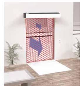
Ajustando los requisitos para la velocidad del aire y la uniformidad del flujo de aire al nivel del suelo, obtendrá una cortina de aire que cubra todo el hueco de la puerta.
