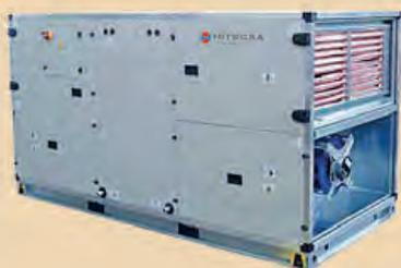
Unidad de ventilación con recuperador estático del tipo aire-aire con flujos cruzados de alta eficiencia, dotado con placas de intercambio de aluminio con cierre de bypass para freecooling y servomotor on/off.
