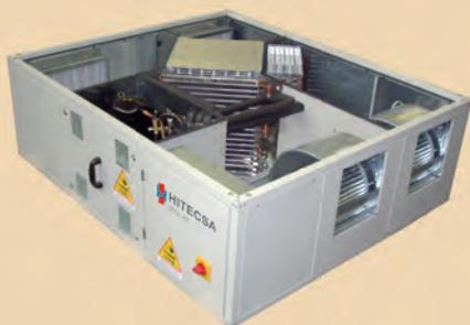
Unidad de ventilación con recuperador de calor estático del tipo aire-aire de flujos cruzados con bandeja de condensados en acero inoxidable, aislada térmicamente
