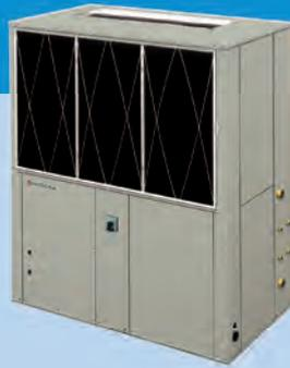
Unidades autónomas del tipo vertical equipadas con condensador de placas refrigerado por agua (uno o dos dependiendo del modelo), adecuadas para operar acopladas a una red de conductos de distribución de aire.
