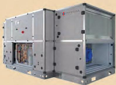
Unidad de ventilación con recuperador estático del tipo aire-aire con flujos cruzados de alta eficiencia, dotado con placas de intercambio de aluminio y circuito frigorífico con cierre de bypass para freecooling y servomotor on/off.
